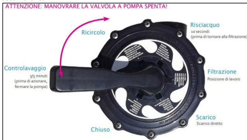
Esempio di posizioni di valvola a 6 vie
